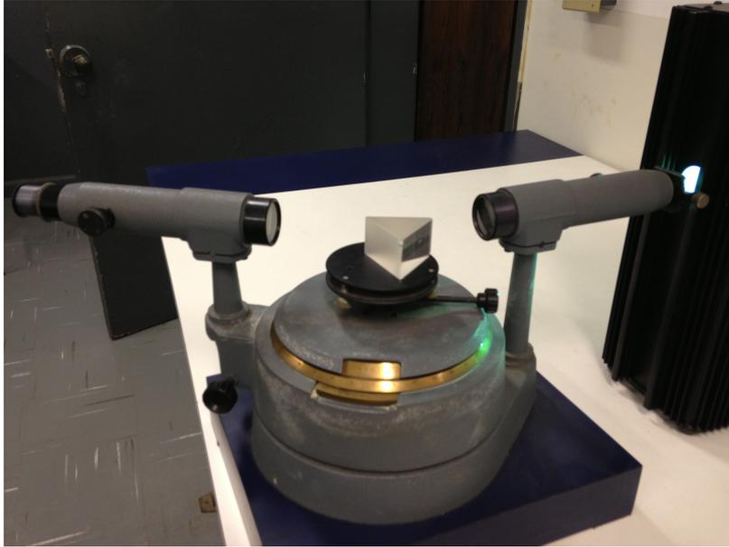
**Figura 4.9:** Espectrômetro de refração.
