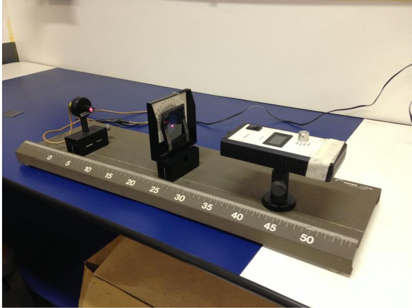
**Figura 5.15:** Aparato experimental para estudo do polarizador e da placa de onda
